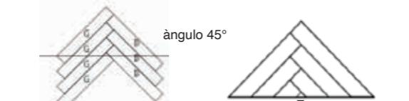
• Una vez obtenido el triángulo (esquema 7), insertarlo dentro de la instalación (8).
